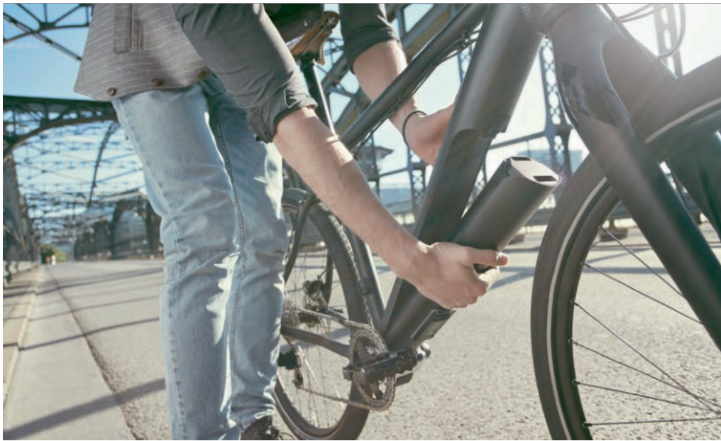
Das Akku-Motor-Getriebe-Package lässt sich mit einem Klick tauschen.
